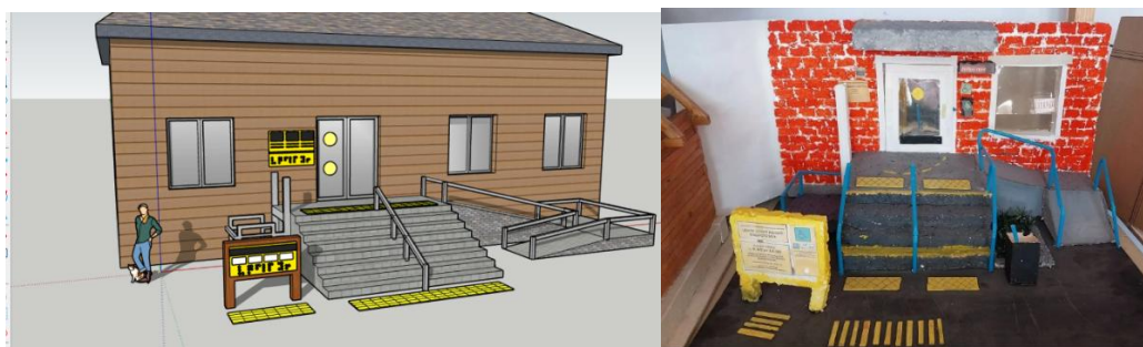
Рис.1 Схема требований к входной группе в программе SketchUp и макет из картона по оформлению безбарьерной среды для всех категорий МГН
