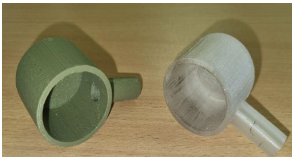
Рисунок 2 - Шаблон для точной разметки полипропиленовых труб
