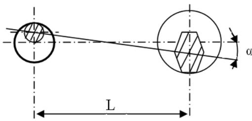
Рисунок 4. Схема установки на два пальца
