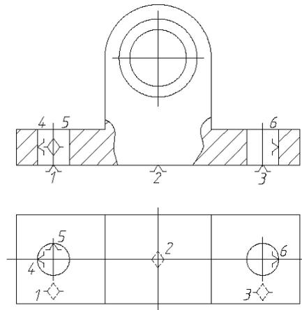
Рисунок 7.Схема базирования кронштейна
