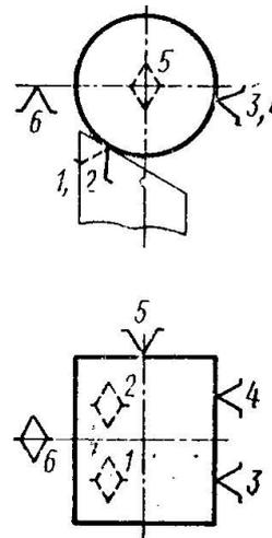
*Примечание:* На теоретических схемах базирования арабскими цифрами 1–6 обозначены опорные точки.
