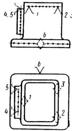
Установка заготовки по обрабатываемой поверхности при бесцентровом врезном шлифовании
