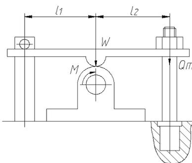
Рисунок. 9. Схема силового замыкания заготовки в приспособлении
