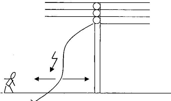
6.2. Величина опасной зоны шаговых напряжений зависит от величины напряжения электролинии. Чем выше напряжение ВЛ, тем большая опасная зона. Считается, что на расстоянии 8 м от места замыкания электрического провода напряжением выше 1000 В опасная зона шагового напряжения отсутствует. При напряжении электрического провода ниже 1000 В величина зоны шагового напряжения составляет 5 м.
