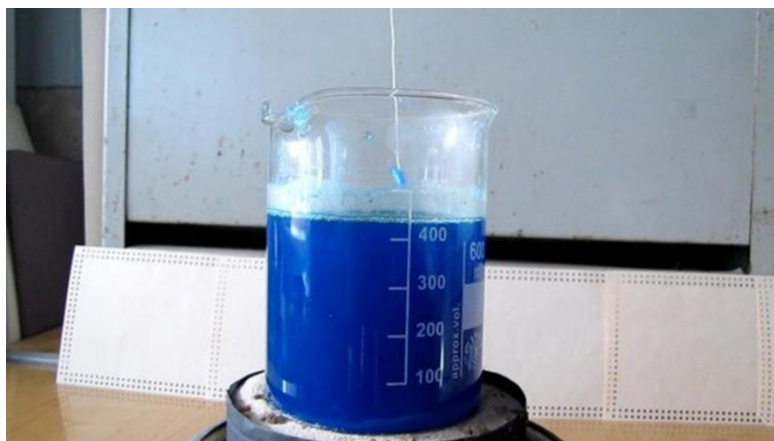
Рисунок 2. Начало процесса кристаллизации
