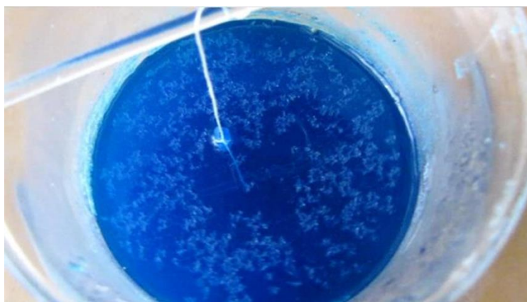
Рисунок 3. Насыщенный раствор купороса образует кристаллы на поверхности раствора
