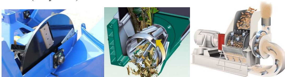
1 – дисковая; 2 – роторная (шредер); 3 – молотковая
