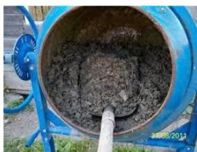
Рис. 1 Перемешивание состава для изготовления блоков
