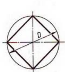
Разделить окружность на 4 и 8 равных частей
