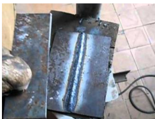
Рис.1 Шов выполнен с предварительным подогревом
