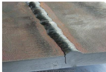
Рис.2 Шов выполнен без предварительного подогрева
