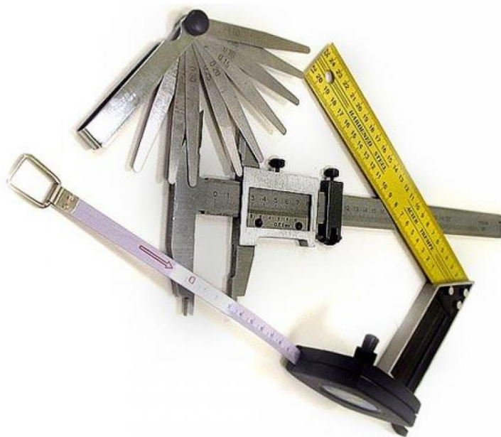
Рисунок 1 Измерительные инструменты для проверки сборки сварных узлов.
