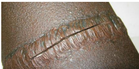
Рис. 1 Сварной шов выполнен без подогрева, Рис.2 Сварной шов выполнен с подогревом
